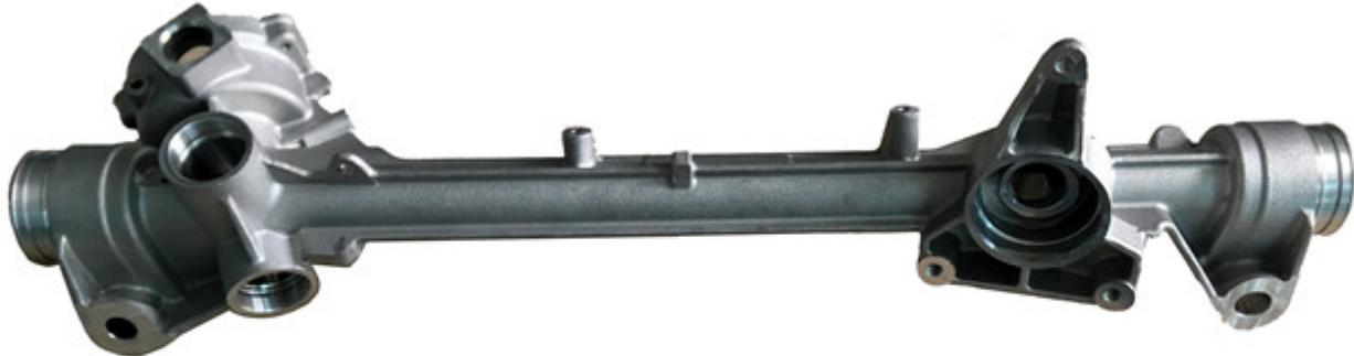
转向器亦称转向机、方向器、方向机，从方向盘的转动程度上可分为三类，分别为可逆式、半可逆式、不可逆式。转向器的作用是将来自转向盘的转向力矩和转向角进行适当的变换，再输出给转向拉杆机构，从而使汽车转向。可逆式转向器是方向盘可以传动转向臂摆动，转向臂也可以传动方向盘转动。半可逆式方向机是方向盘可以传动转向臂上，只有在相当大的力臂作用下，转向臂才可转动方向盘。汽车多数采用半可逆式方向机，车辆在一般道路上不因车轮的摆转回冲使方向盘旋转。不可逆式方向机的方向盘能传动转向臂，方向盘回转退步时转向臂才可以反回，这类方向机是用在大型载重车上。
